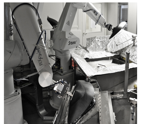
涂装系统中两台史陶比尔喷涂机器人RX160在狭小空间内协同工作
