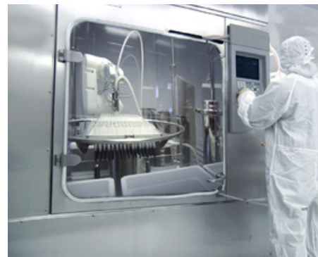
Isolateur aseptique avec robot 6 axes à bras articulé Stäubli Stericlean.
