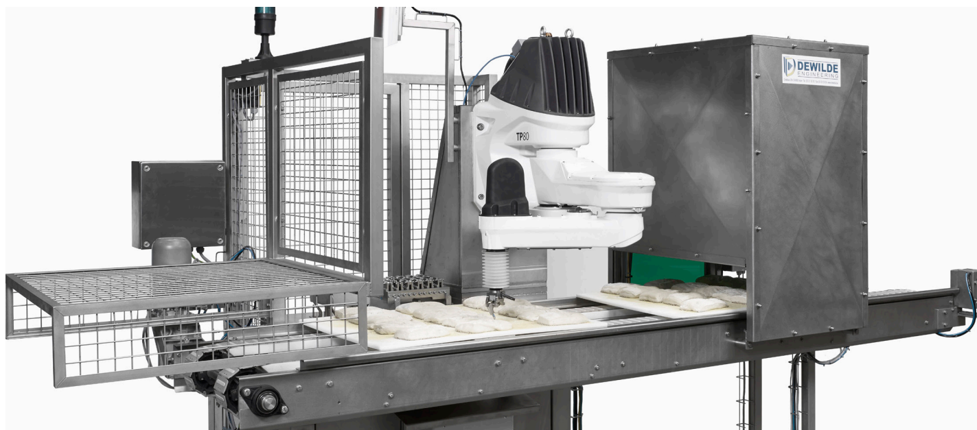
Le robot TP80 entaille avec précision les pâtons avant cuisson selon des paramètres prédéfinis.
