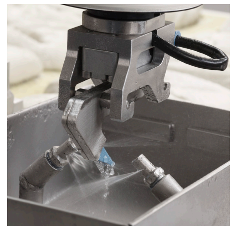
Nettoyage et humidification automatisés de la lame
