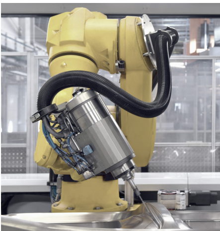
Précision maximale requise : le Staubli TX200 perce un trou pilote.
