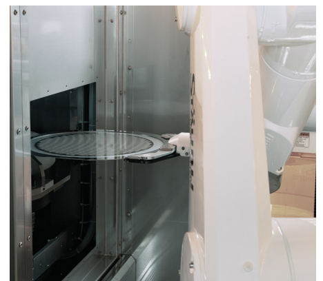
Sämtliche Handlungsaufgaben innerhalb der Anlage übernimmt der hochpräzise Staubli-Reinraumroboter TX60L cr.
