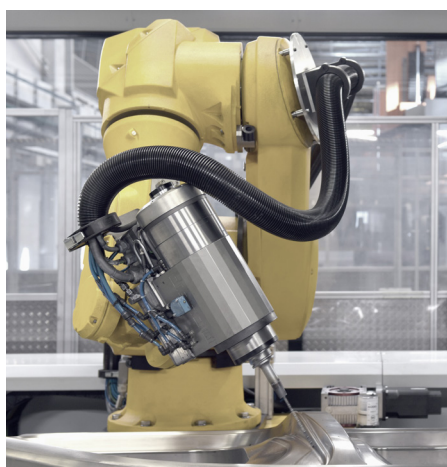
Höchste Präzision gefragt: der Staubli TX200 bei einer Messbohrung.
