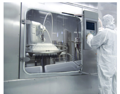
Aseptischer Isolator mit Stäubli Sechssachser in Stericlean-Ausführung.
