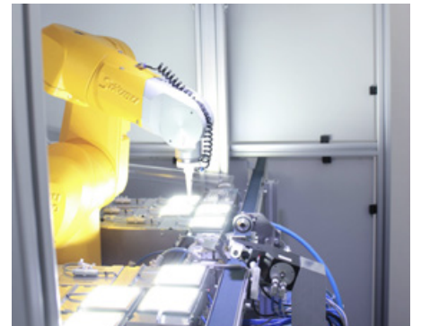
Ein kompakter Stäubli TX40 punktet bei der Handhabung der Prothesenzähne mit Präzision, Speed und Zuverlässigkeit.
