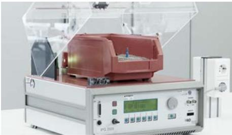
Pendant le contrôle, il ne doit survenir ni claquage ni percement.
