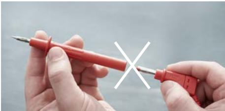
Ne jamais brancher de pointes de test ou de pinces tenues à la main sur une fiche à cosse rétractable !
