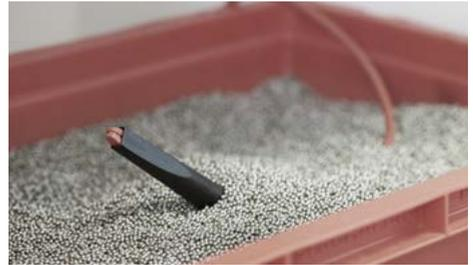
Essai à la tension par immersion dans un bain de billes
