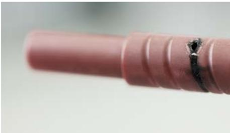
Percement si les connecteurs ne sont pas conformes à la norme
