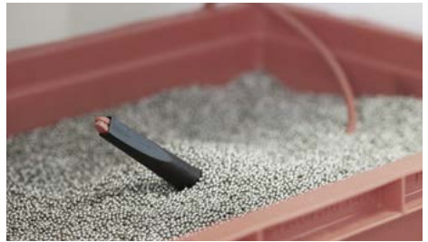
在射浴中进行电压测试
