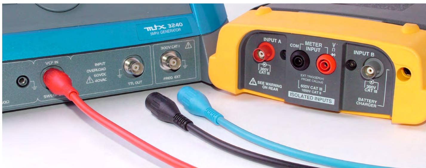
配有带触摸保护的 BNC 插头的测试导线可以连接具有绝缘及常规 BNC 插座的设备。
