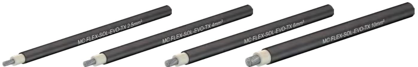
Câbles photovoltaïques sans halogène, à faible dégagement de fumée, flexibles, monoconducteurs, à double couche réticulée, destinés en particulier à une utilisation du côté courant continu (DC) des systèmes photovoltaïques. Ces câbles sont conçus pour s'adapter à la plupart des composants PV correspondant à la classe II avec une tension nominale en courant continu d'1,5 kV (IEC) entre les conducteurs et entre le conducteur et la terre. La tension de fonctionnement maximale autorisée en
