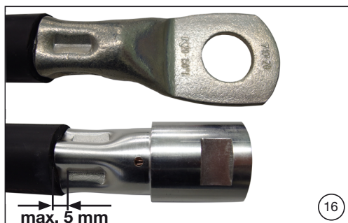
(图 16) 最大 150 mm 2 , 需要 1 次压接。压接可以与边缘齐平, 最大为 5 mm。
