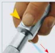
**1 Impulsion 1 :** décompression automatique du flexible aval et maintien de l'about en position parking dans le raccord.
