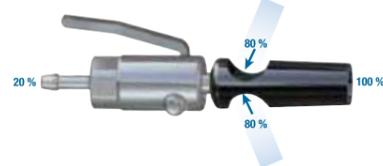
Débit maximal et consommation minimale par l'effet Venturi qui nécessite 80 % d'air extérieur et seulement 20 % d'air comprimé, conduisant à un soufflage basse pression.
