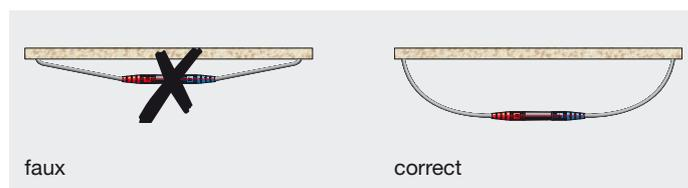
3. Lorsque plusieurs connecteurs sont mis côte à côte, le croisement de câbles doit être évité. Les cordons et câbles doivent être de longueur suffisante.
