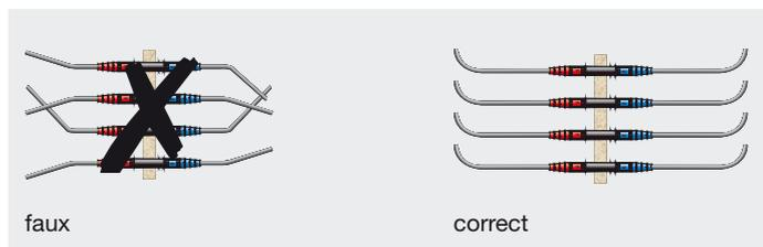
4. Dans le cas de connecteurs multipolaires, afin d'absorber les tolérances de construction, un côté (douille ou broche) ou les deux côtés devrai(en)t être monté(s) flottant(s).
