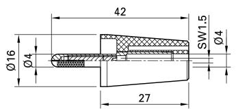
Adapter aus Messing zum Festschrauben in Ø 4 mm-Buchsen. Durch Anziehen einer Innenschraube spreizt sich der Ø 4 mm-Stecker dieses Adapters auf, so dass er fest in der Buchse sitzt und im montierten Zustand vollen Berührungsschutz bietet. Starre Ø 4 mm-Buchse im Isolierkörper,
