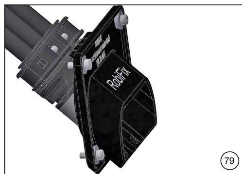
(ill. 79) Schaltschrankeinbau mit montierten Buchsenteil RobiFix-B..-MTB
