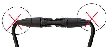
Kabel te sterk gebogen nabij de connector Too much bend of cable close to connector
