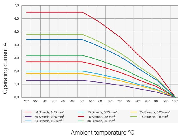
**NBR/CR: Cable 0.75 mm<sup>2</sup> & 1 mm<sup>2</sup>**
