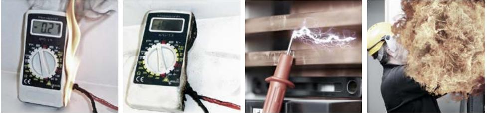
Según el contenido energético de un circuito de medición, las consecuencias de un cortocircuito pueden ser desastrosas.
