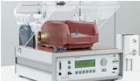
Durante la prueba, no se permiten rupturas ni disrupciones.
