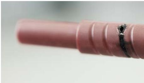
Ruptura en conector enchufable no normalizado
