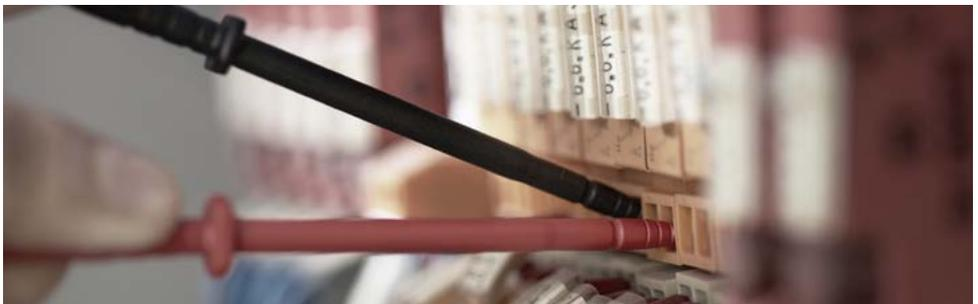
Mediciones en cajas de fusibles e interruptores
