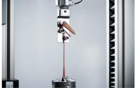
**Prueba de la flexión de tracción y de la flexión de torsión**
