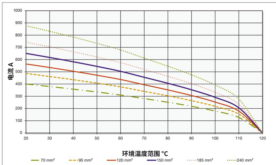
绝缘铜导线的降容曲线 (IEC 60364-5-52), 最大 90 °C, (例如 PUR)
