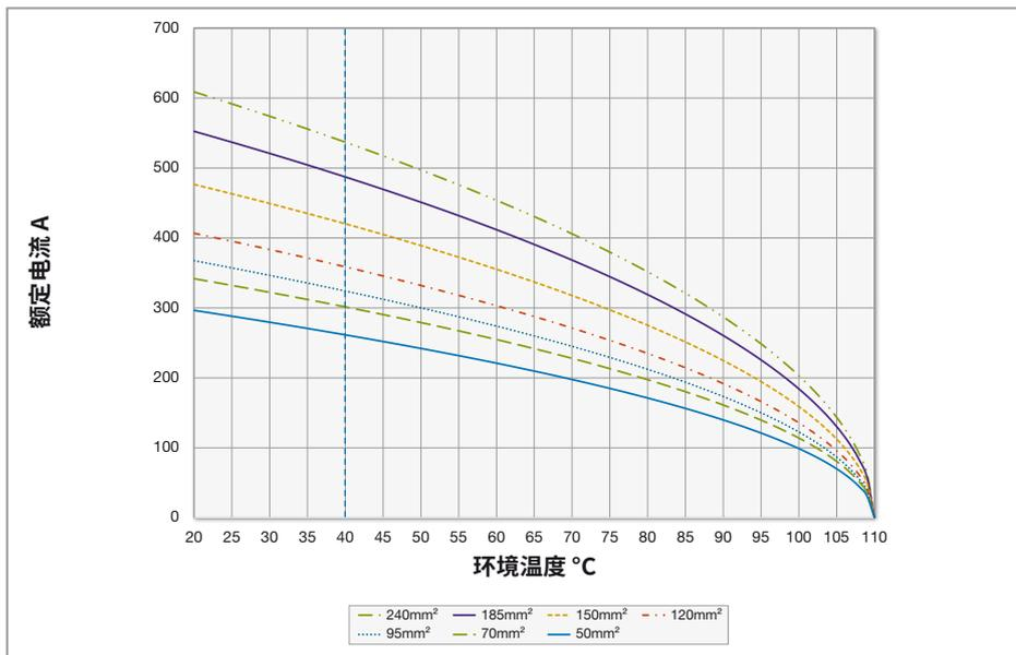
绝缘铜导线的降容曲线 (IEC 60364-5-52), 最大 120 °C, (例如 RADOX®)
